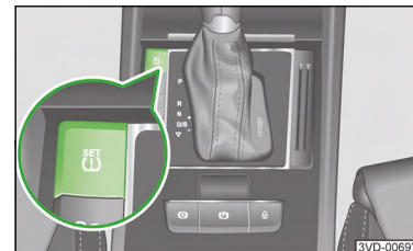
شکل ۱۴۷ سیستم کنترل فشار باد لاستیک سوئیچ تنظیم
