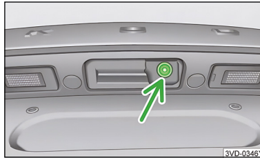
شکل ۱۱۹ داخل درب صندوق عقب خودرو: محل نصب دوربین دنده عقب
